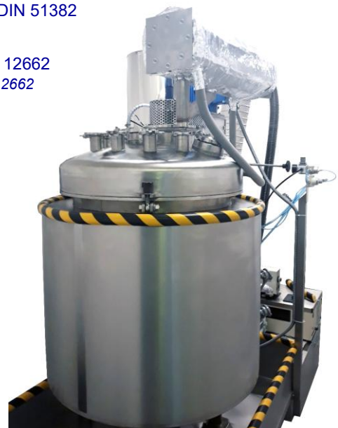
Apparat zur Herstellung von künstlich gealterten Schmierölen Device to Produce Artificial Altered Lubricants
