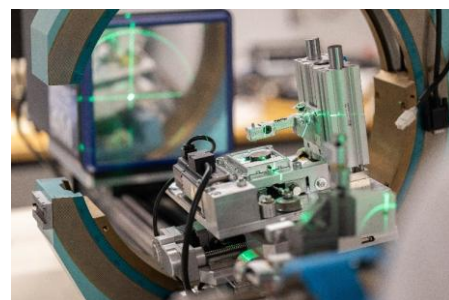
Labora Aufbau mit offener Röntgenquelle für In-situ-Untersuchungen Lab-setup open X-ray source for in-situ studies
