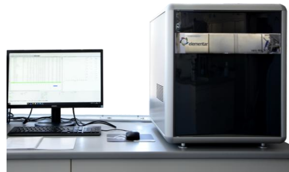
Quantitative Elementanalyse für C, H, N, S und O in organischen Verbindungen Quantitative Analyses for C, H, N, S, and O in Organic Compounds
