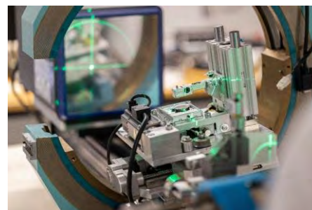
Offene Röntgenquelle für In-situ-Untersuchungen Open X-ray source for in-situ studies
