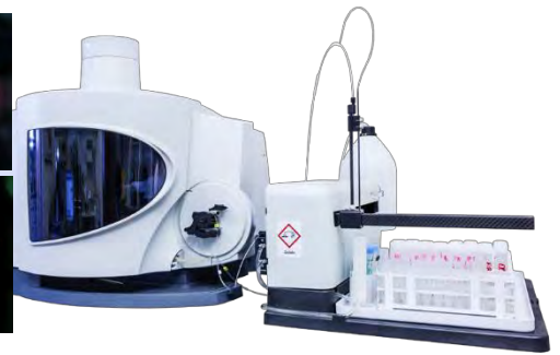
Atomemissionsspektrometer; Analysechamber mit Plasmafackel ICP-OES; Analysis Chamber with Plasma Torch
