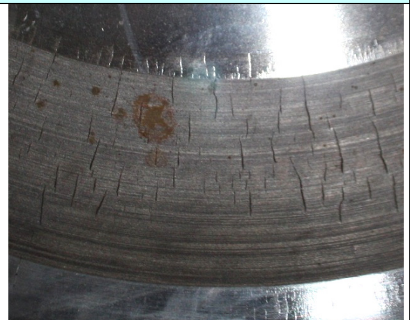
Abbildung 1: Tiefe Risse auf einer Bremscheibe
