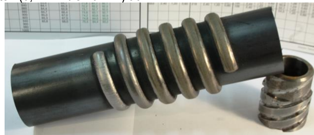
Bild 2: Lasergeschweißte Schneckengänge auf Baustahlrohr
