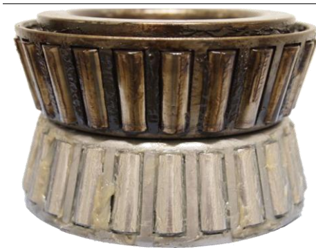
Abb. 2: Geschädigtes Lager durch Verkokung des Schmierfetts (oben) und neues fettgeschmiertes Lager (unter Bildhälfte)
