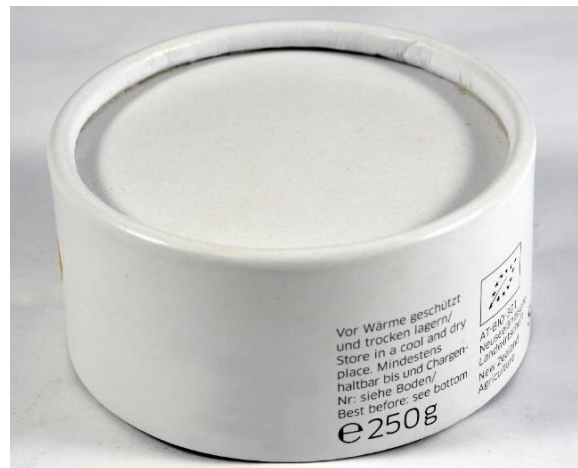
Abb. 1: Mittels Bördelung geformter Boden einer zylindrischen Lebensmitteldose (© V-Research GmbH)
