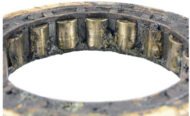
Lagerschaden infolge einer Fettschädigung (Foto: AC2T research GmbH)
