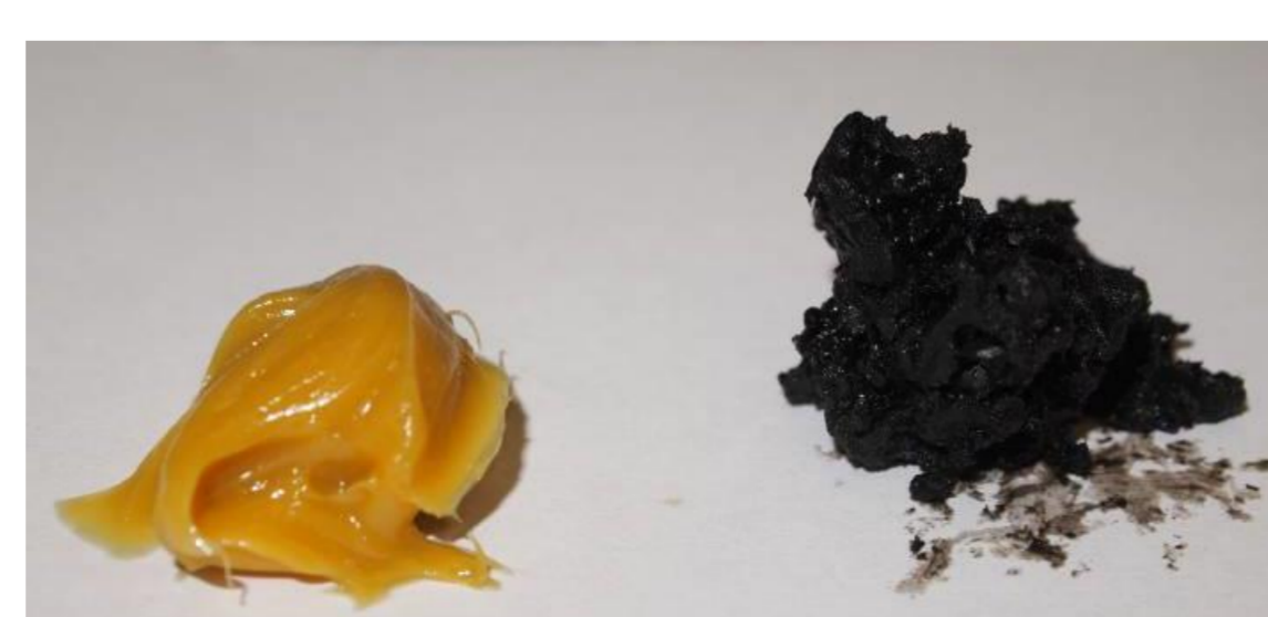
Zwei Fette vor (jeweils links) und nach (jeweils rechts) der Alterung; rechtes Bild: das im Bild rechts dargestellte Fett ist deutlich verkocht, während das dargestellte Fett im Bild links kaum Alterung zeigt.
