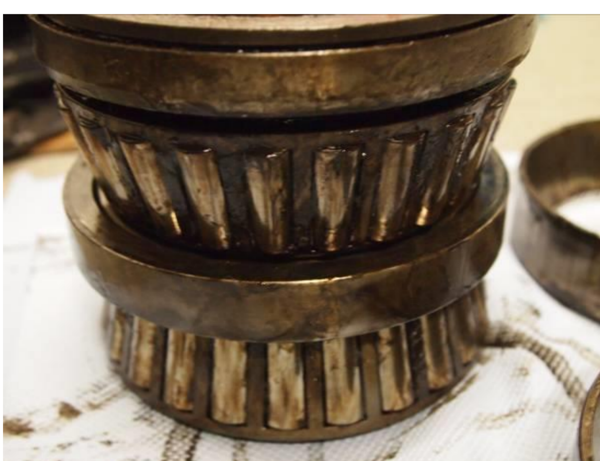
Normale Gebrauchsspuren: Innenleben gebrauchter Radlager
